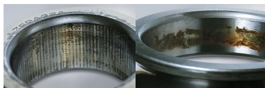
图 2 轴承微动磨损引起的套圈损伤
